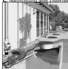
c. Nachrüstung alter Zisternen
